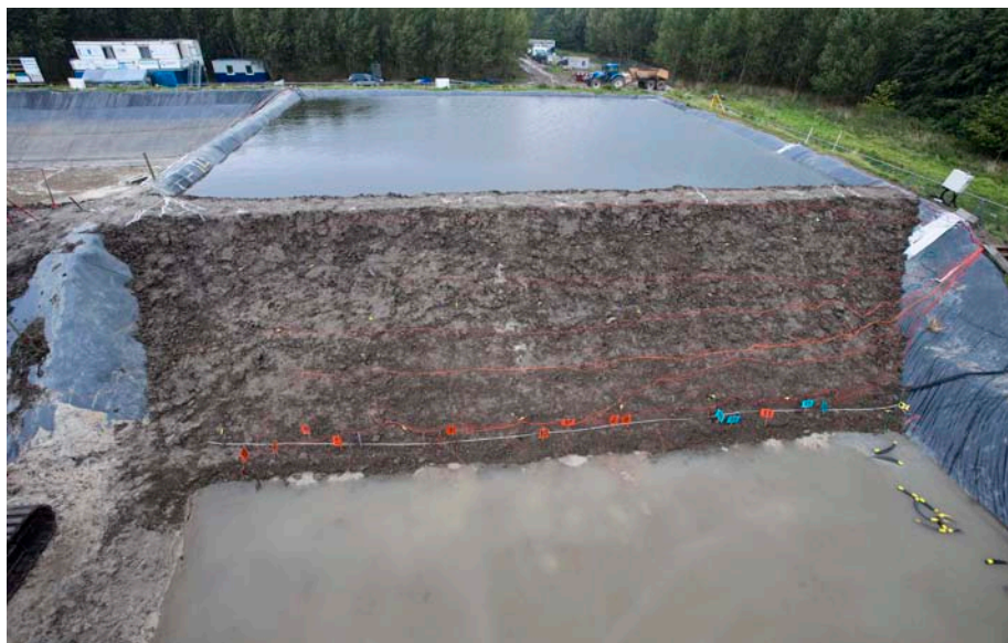
Een pipingproef met verticaal zanddicht geotextiel in september 2012.
